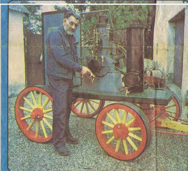
Samlingens eneste lokomobil. Motoren kører på ræle og blev med hestekraft trukket rundt til landmænd, der var medlemmer af tærskeløberingen.
